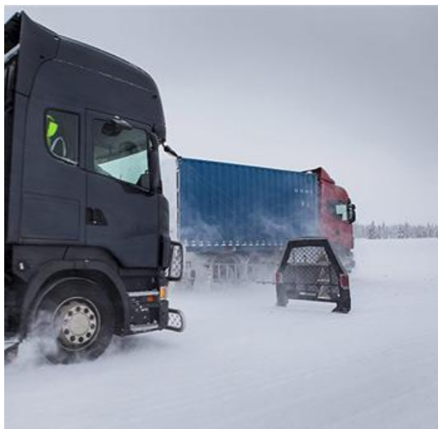
圖 4. AEBS 軟體的控制道路測試。兩輛車之間的梯形物件為一個設計作為類似一輛車的”軟目標”，用來”欺騙”雷達以及攝影機。
