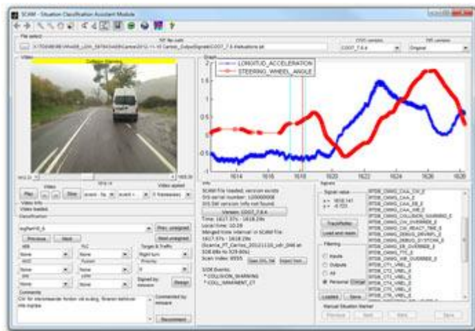
圖 5. 以 MATLAB 為基礎的工具 – Situation Classification Assistant Module，用來處理裝載的 ECU 資料，並自動辨識與緊急煞車相關的情況。
